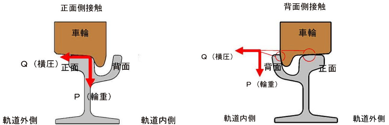
図 2 : 横圧と輪重のイメージ
