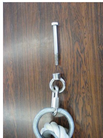
金具が外れた状況
