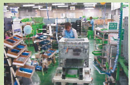
「セル生産方式」 一人完結で約90分の複写機組立作業
