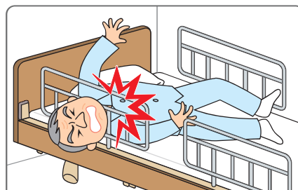
サイドレール内のすき間
