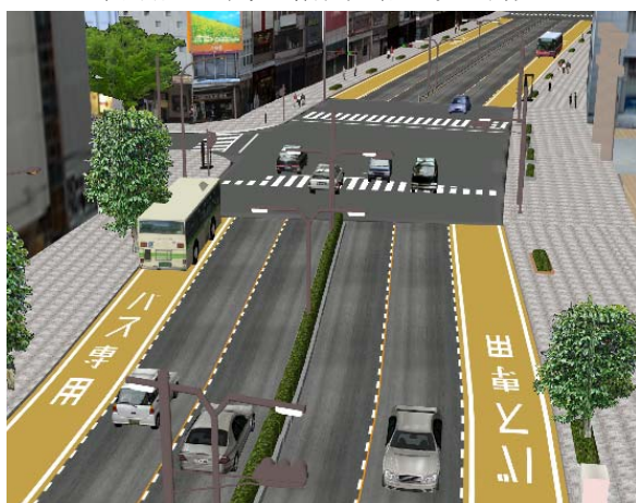
図-10：バス専用レーンの設置
