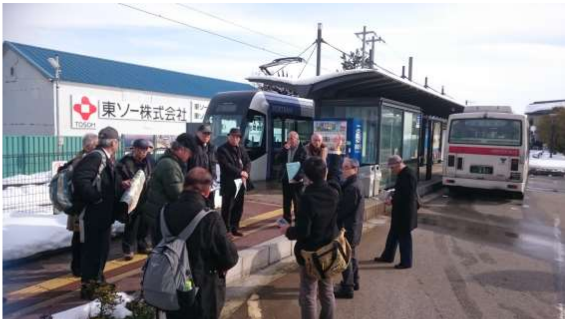
△岩瀬浜停留場でのLRTとフィーダーバスの接続。停留場の地面からの高さはバスの乗降口に合わせて通常より高く設定している。
