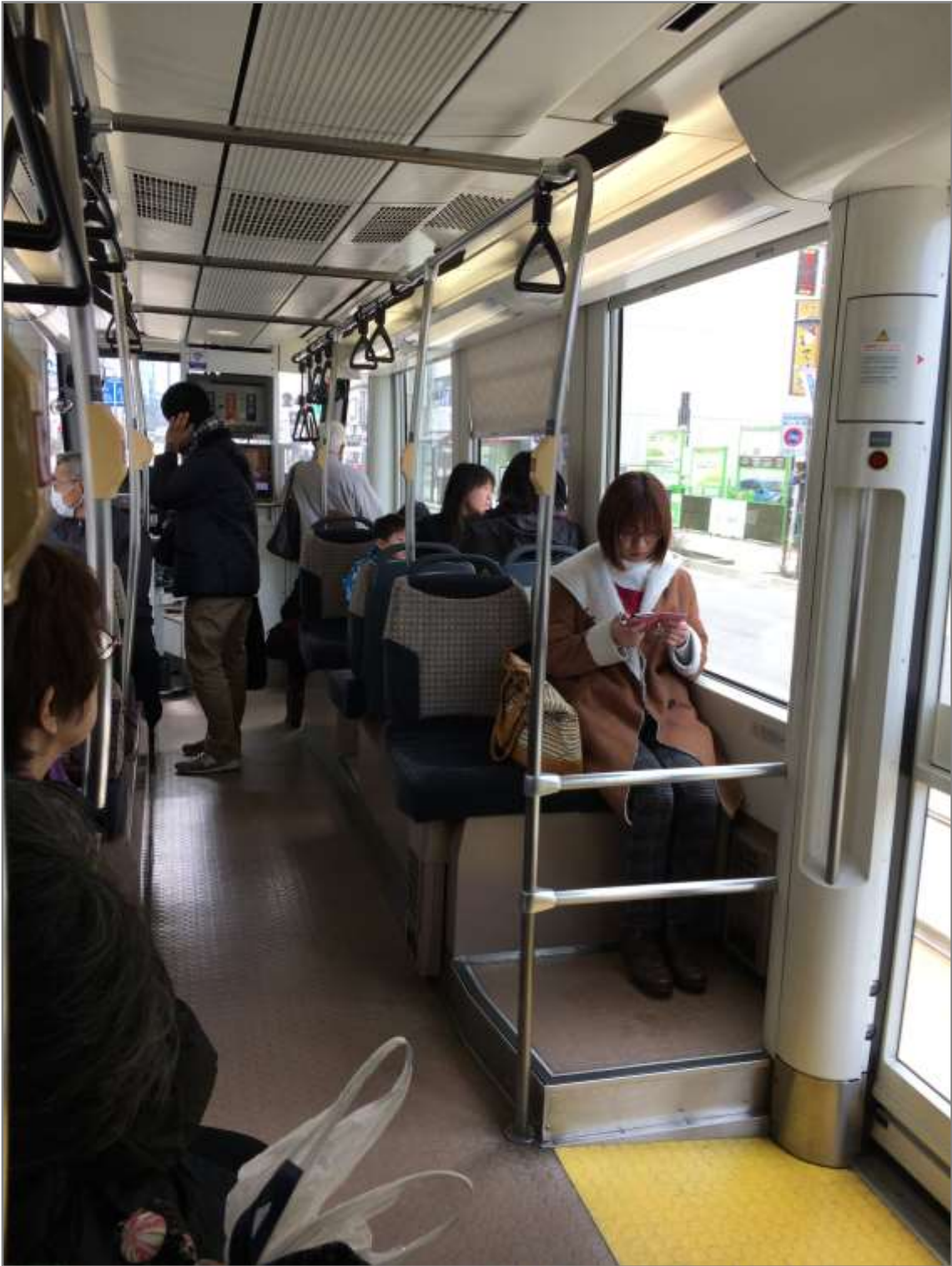
富山市内環状線（セントラム）の車内の様子です。 車内の平らな様子が分かります。
