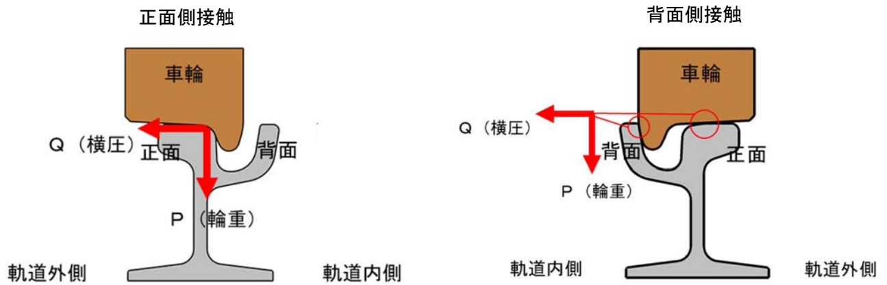
図 2 : 横圧と輪重のイメージ
